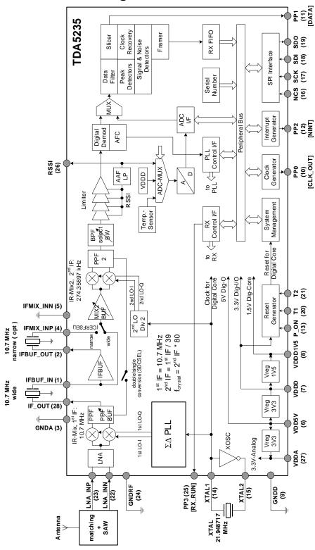
Figure 2 TDA5235 Block Diagram<sup>1)</sup>
